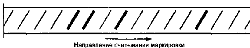
Рисунок 2 — Пример прокатной маркировки предприятия-изготовителя под номером 14
